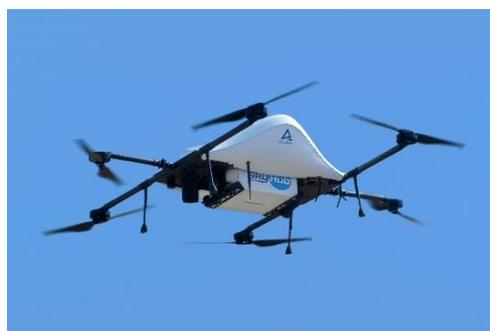
エアロネクストの物流専用ドローンの最新試作機
